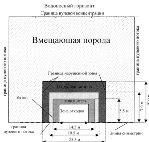
Рис. 2. Схематическое представление концептуальной модели ближнего поля для горизонтальной выработки
