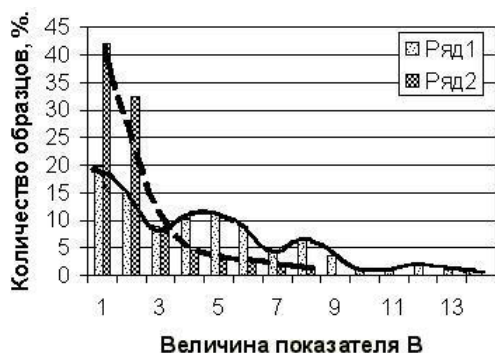
Рис. 3. Распределение образцов пород СГ-3, отобранных по всему разрезу скважины (ряд 1) и их гомологов с поверхности (ряд 2) по величине показателя упругой анизотропии V.
