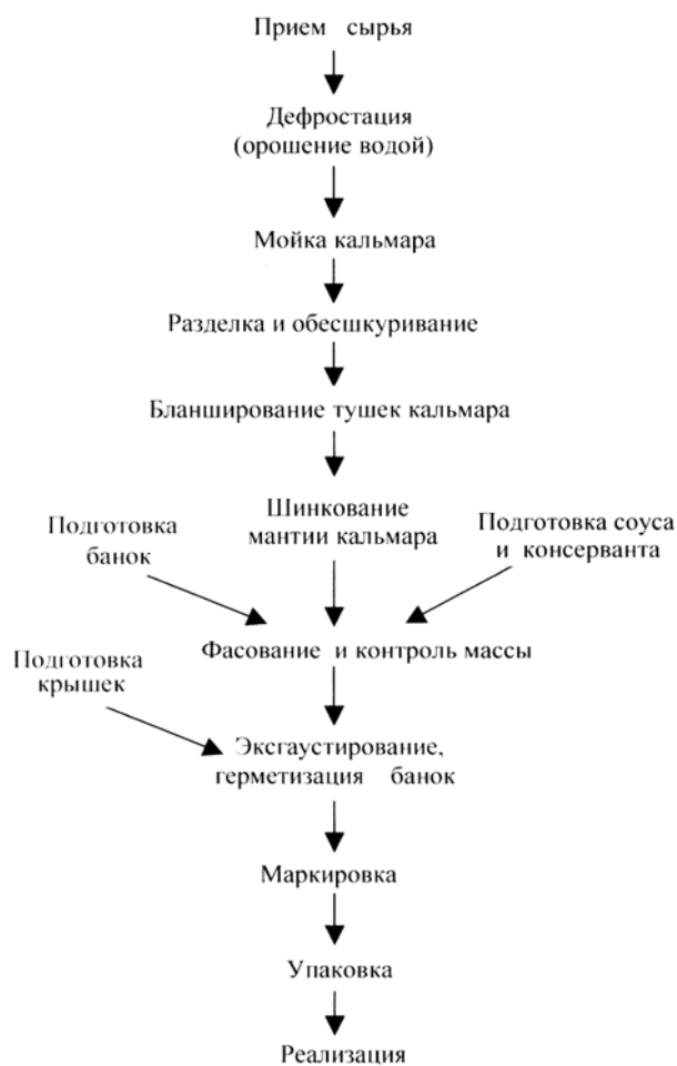
Рис. 2. Технологическая схема производства пресервов из бланшированного полуфабриката кальмара
