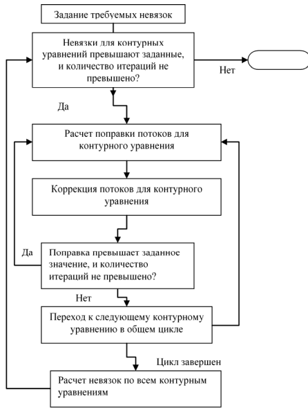
Рис. 1. Блок-схема алгоритма решения системы нелинейных уравнений
