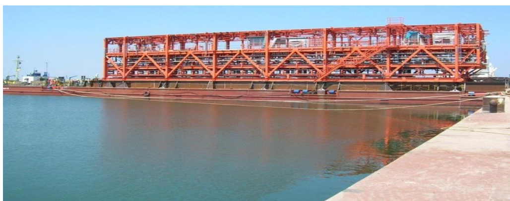
Рис. 5. Погрузка технологического модуля на плавучий понтон ТМИ-5 в порту Равенна (Италия) методом наката; http://arcticroad.ru/
