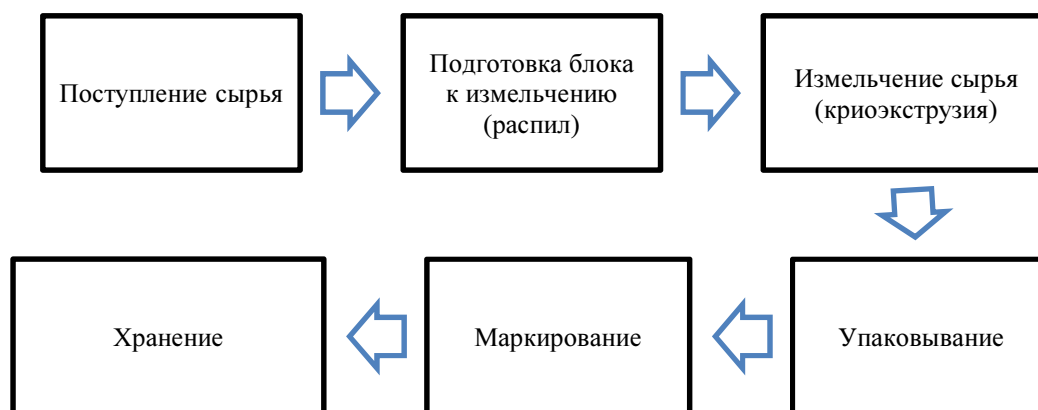
Рис. 3. Схема технологического процесса производства кормового рыбного фарша (криофарша)
