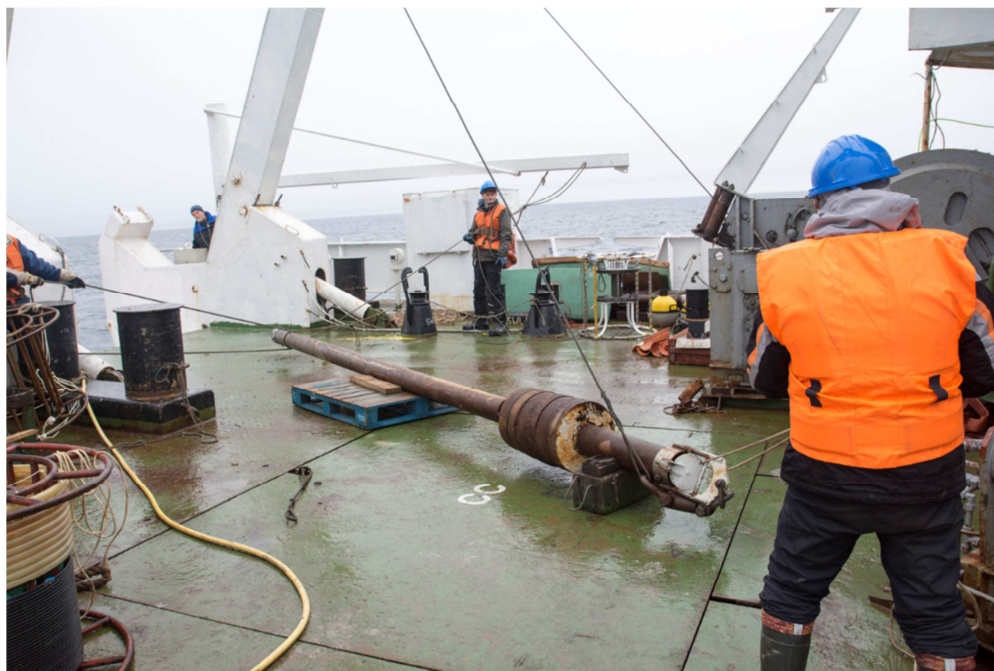
Рис. 2. Спускоподъемные работы с использованием УГТ-147 на корме НИС "Академик Николай Страхов"
