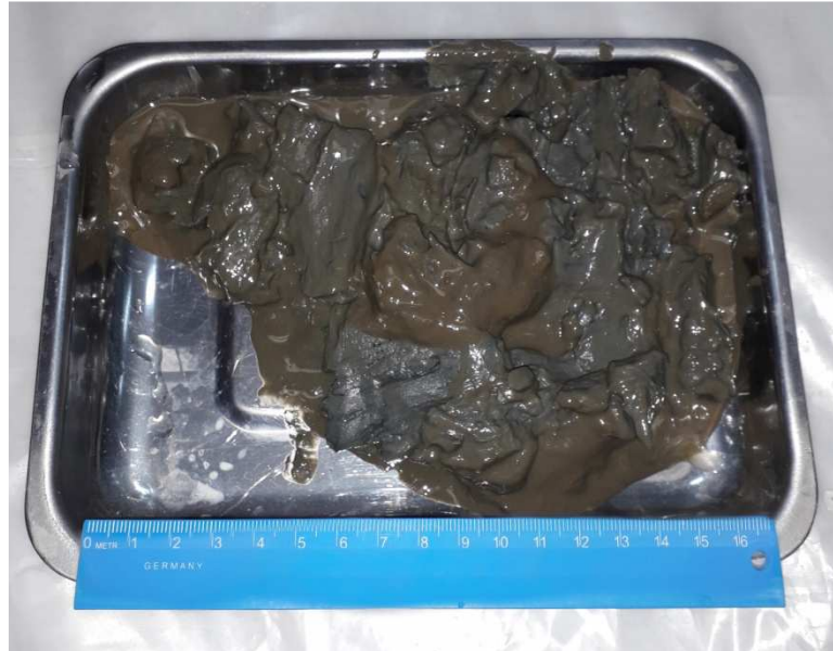
Рис. 3. Пелитовые илы оливкового цвета Fig. 3. Olive green pelite muds
