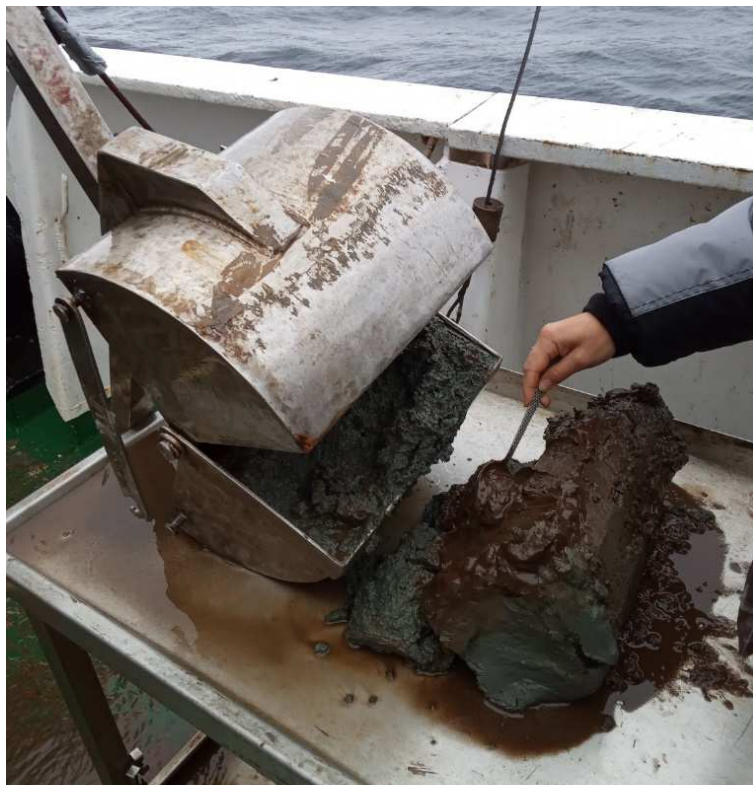
Рис. 2. Отбор проб с помощью дночерпателя VanVeen-0,1 Fig. 2. Sampling with the grab VanVeen-0,1
