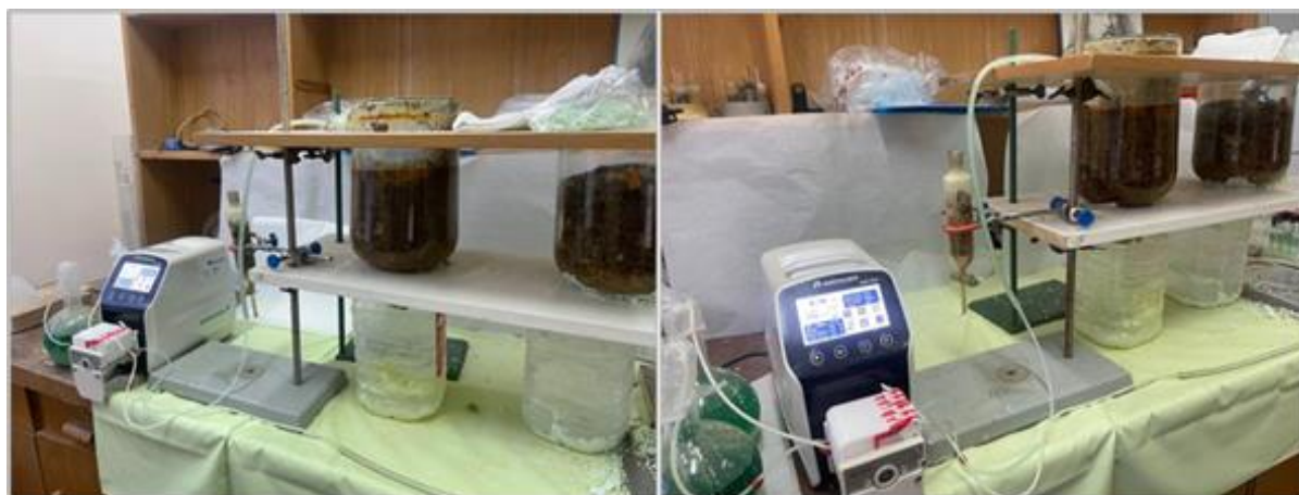
Рис. 2. Лабораторная установка для моделирования кучного выщелачивания Fig. 2. Laboratory equipment for heap leaching modeling
