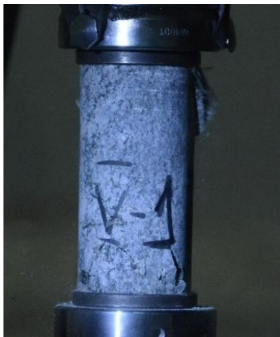
Рис. 1. Испытание образца горной породы при одноосном сжатии Fig. 1. Rock sample testing under uniaxial compression
