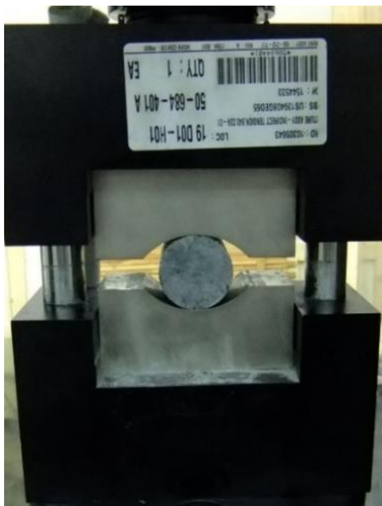
Рис. 2. Испытание образца горной породы при одноосном растяжении Fig. 2. Rock sample testing under uniaxial tension
