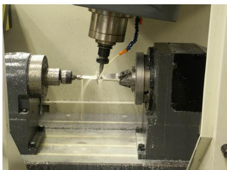
Рис. 5б. Чистовая обработка (спиральная) лопатки
